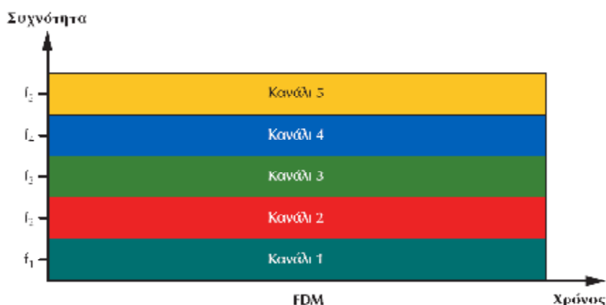
Εικόνα 14: Τεχνική πολυπλεξίας διαίρεσης συχνότητας. Η γρήγορη γραμμή επικοινωνίας χωρίζεται σε κανάλια, όπου σε κάθε κανάλι περνάει ένα σύνολο συχνοτήτων.
