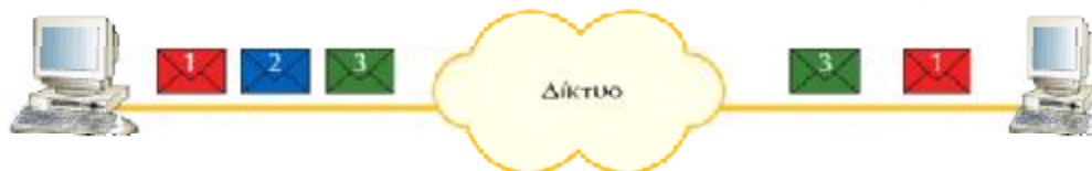
Εικόνα 7: Στην υπηρεσία χωρίς σύνδεση τα πακέτα μεταφέρονται με τυχαία σειρά και δεν υπάρχει εγγύηση ότι θα παραληφθούν χωρίς λάθη
